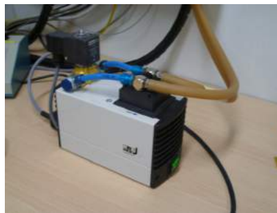
FIGURE 8.12.4 – Pompe de mise en pression du vase d'hélium liquide
