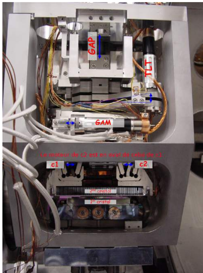
FIGURE 1.3.1 – Montage des deux cristaux du monochromateur
