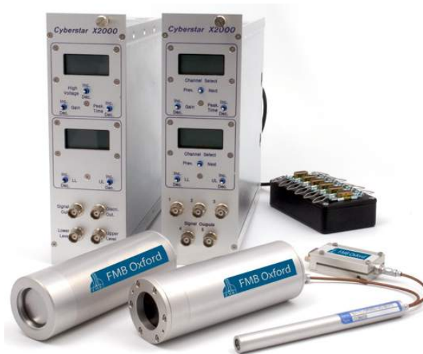
FIGURE 7.4.1 – Photo-multiplicateurs et électronique associée (Cyberstar X2000)
