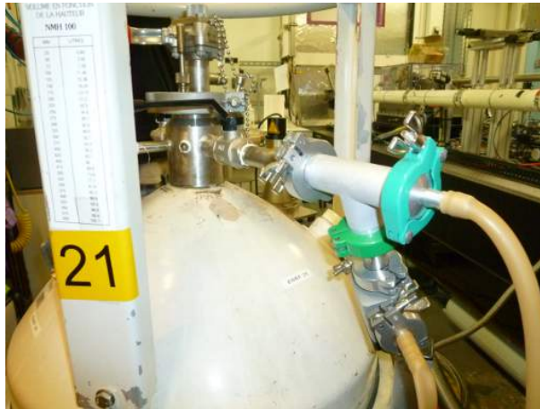
FIGURE 8.12.2 – T à monter sur le vase d'hélium liquide
