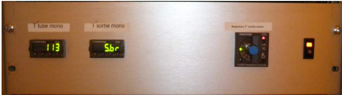
FIGURE 1.3.3 – Température de la sortie d'azote (dans le double-paroi et bas du tube).
