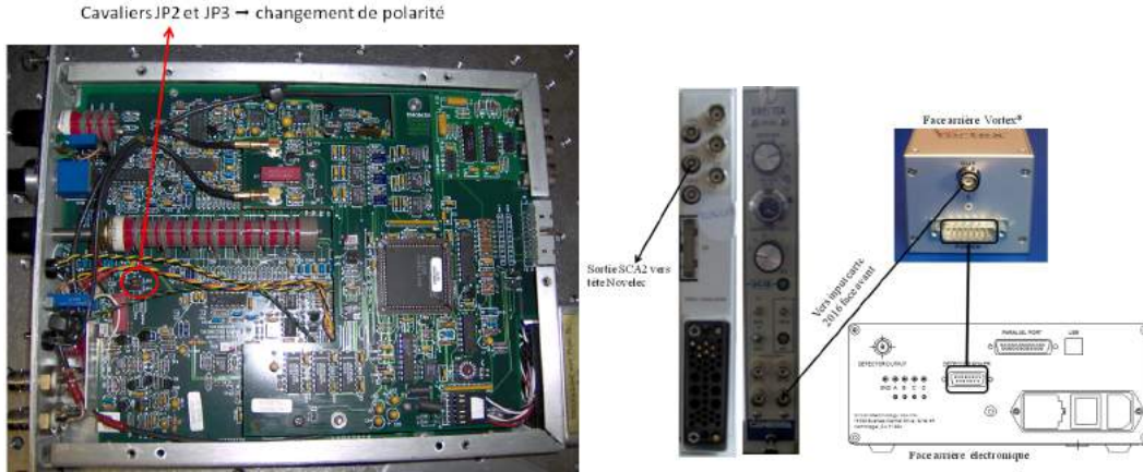
FIGURE 7.3.1 – Intérieur, faces avant et arrière de la carte 2016, face arrière du Vortex
