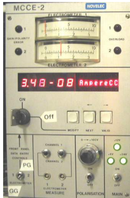
FIGURE 7.1.6 – Boîtier MCCE permettant le dialogue avec les têtes de conversion Novelec d’une part, la lecture directe des courants mesurés par les diodes d’autre part.
