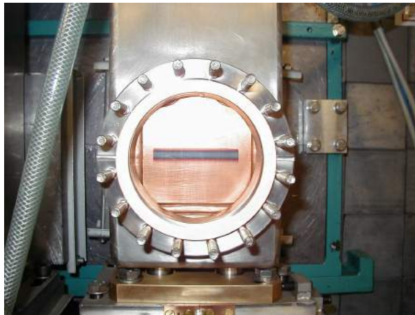
FIGURE 2.1.1 – Shutter dans OH1 (impact du faisceau blanc sur le bloc de cuivre refroidi)
