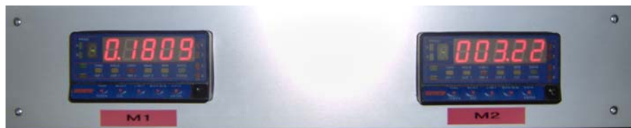
Figure 2: Affichage des inclinomètres des miroirs pendant leur installation (Octobre 2008 - William Del Net)
