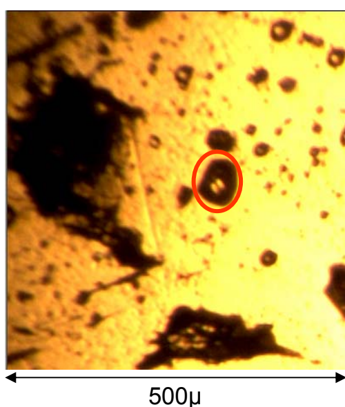
Figure 9 : Inclusion fluide « vapeur » Yankee Lode sondée. Image au microscope optique utilisé pour le positionnement de l'échantillon sur la ligne -
